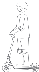
通過擠壓剎車杆， 以啟動前輪電剎及後輪碟剎系統
